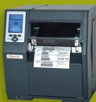
6-дюймовые принтеры H-класса серии "X" (повышенной емкости) – это более крупное внутреннее устройство перемотки и расширенный дисплей передней панели. Удобный в работе графический ЖК-дисплей в девять раз больше обычного, что
